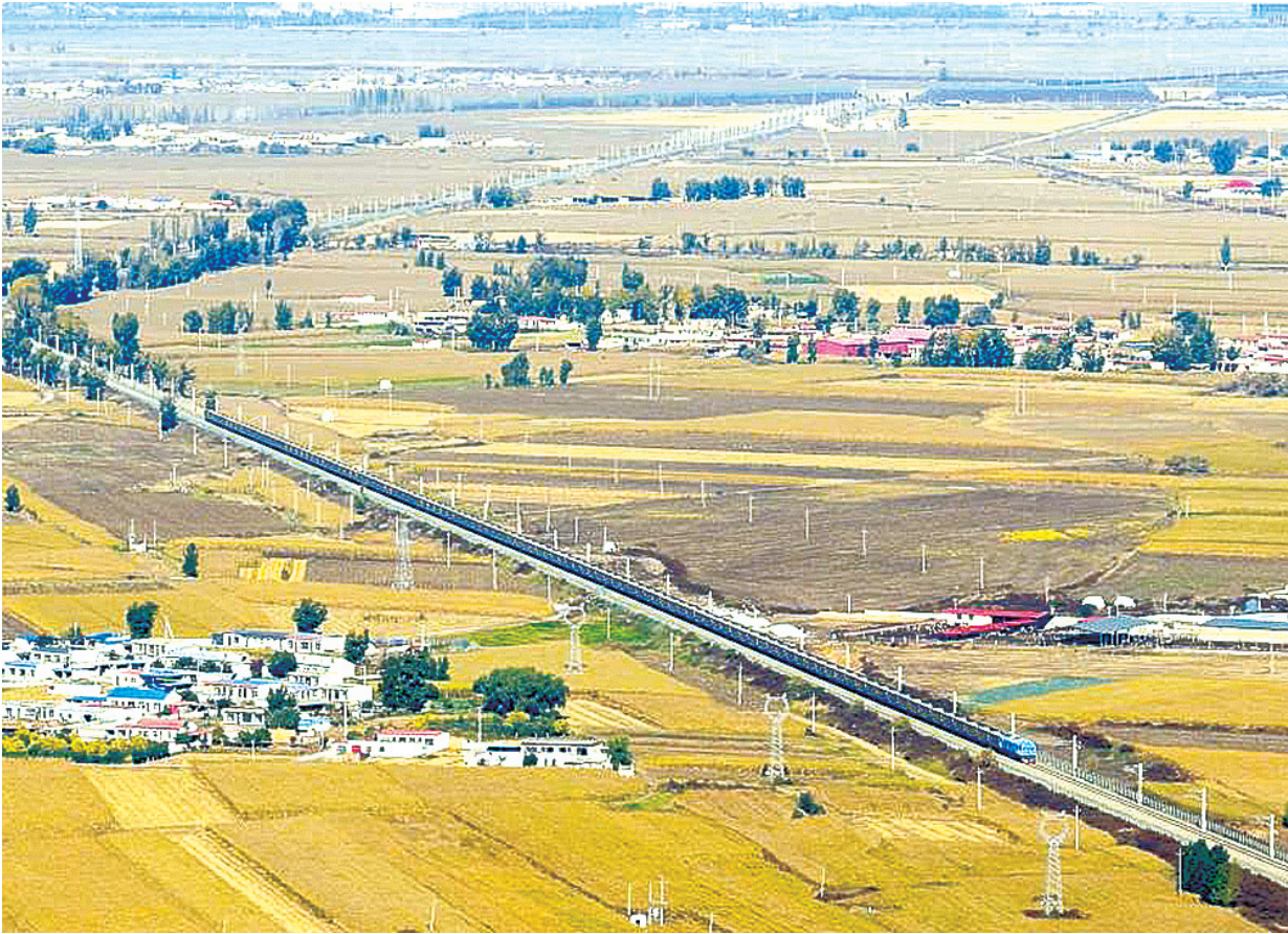
12月8日,7列5000吨级货运重载列车在位于内蒙古包头市的包神铁路集团万水泉南站南场实现自动解编、有序进站,成功实现世界首列3.5万吨级重载群组列车试验开行。(无人机照片)。
