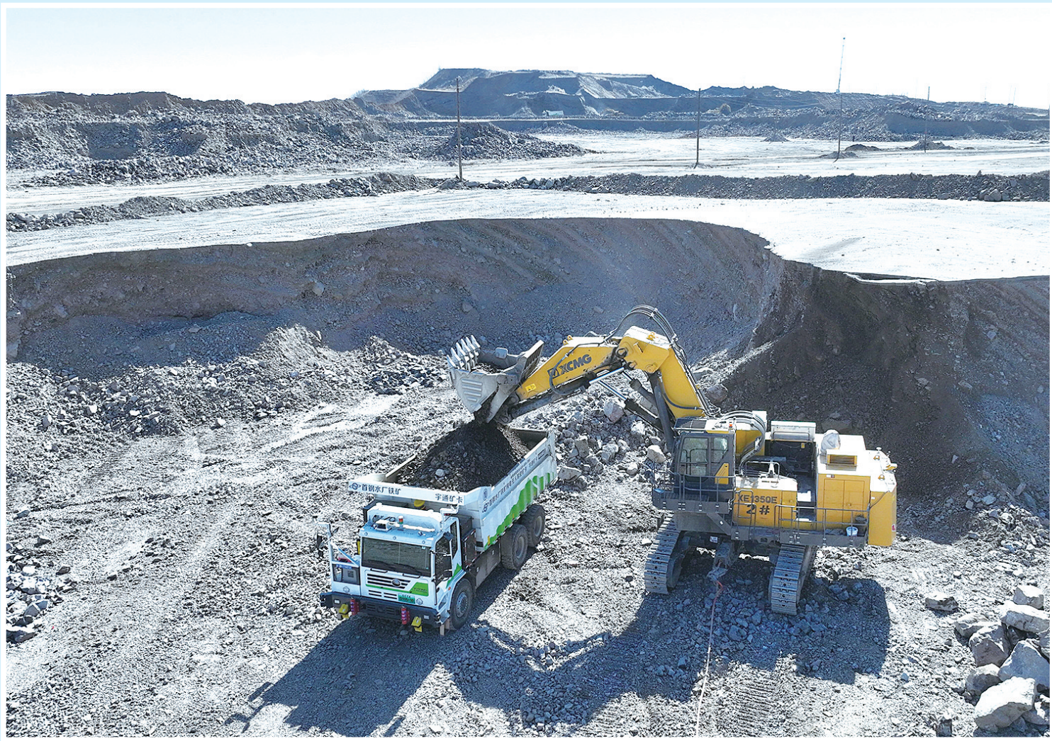
3月18日，河北省迁安市首钢矿业水厂铁矿的电动无人驾驶矿卡停在采矿界面装矿石。近日，河北省迁安市首钢矿业水厂铁矿引进的电动无人驾驶矿卡在建材产线实现规模化应用，运输实现了自动化、智能化、低碳化。据介绍，该电动无人驾驶矿卡依托5G、人工智能、物联网等现代信息技术，实现了运输、装载、翻卸、启停全流程无人驾驶全天候平稳有序运行，同时节约近50%人力，为冶金矿山行业绿色发展提供了强有力的支撑和更好的智能化转型升级解决方案。
