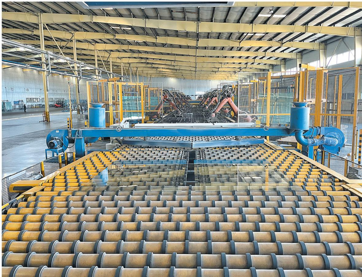
金星玻璃工业双辽有限公司主要生产优质浮法汽车玻璃原片(包括着色玻璃),部分产品出口俄罗斯,可实现年产值4.06亿元。这是金星玻璃生产车间正在生产玻璃。
