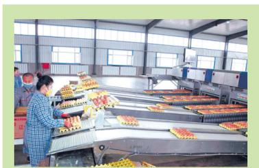
一车车以四平优质玉米为主原料的饲料隔着围墙被输送到指定粮仓;一枚枚刚下的鸡蛋自动排列,沿流水线经过检测、分重、装盘后装箱;一车车鸡粪运入有机肥厂,经过高温发酵成有机肥;一只只蛋鸡在养殖场住着恒温定湿的“楼房”茁壮成长,上料、喂水、调温、控湿、集蛋等一键操作……这些画面是吉林省辽牧生态农业科技有限公司全产业链发展养鸡业的真实写照。
