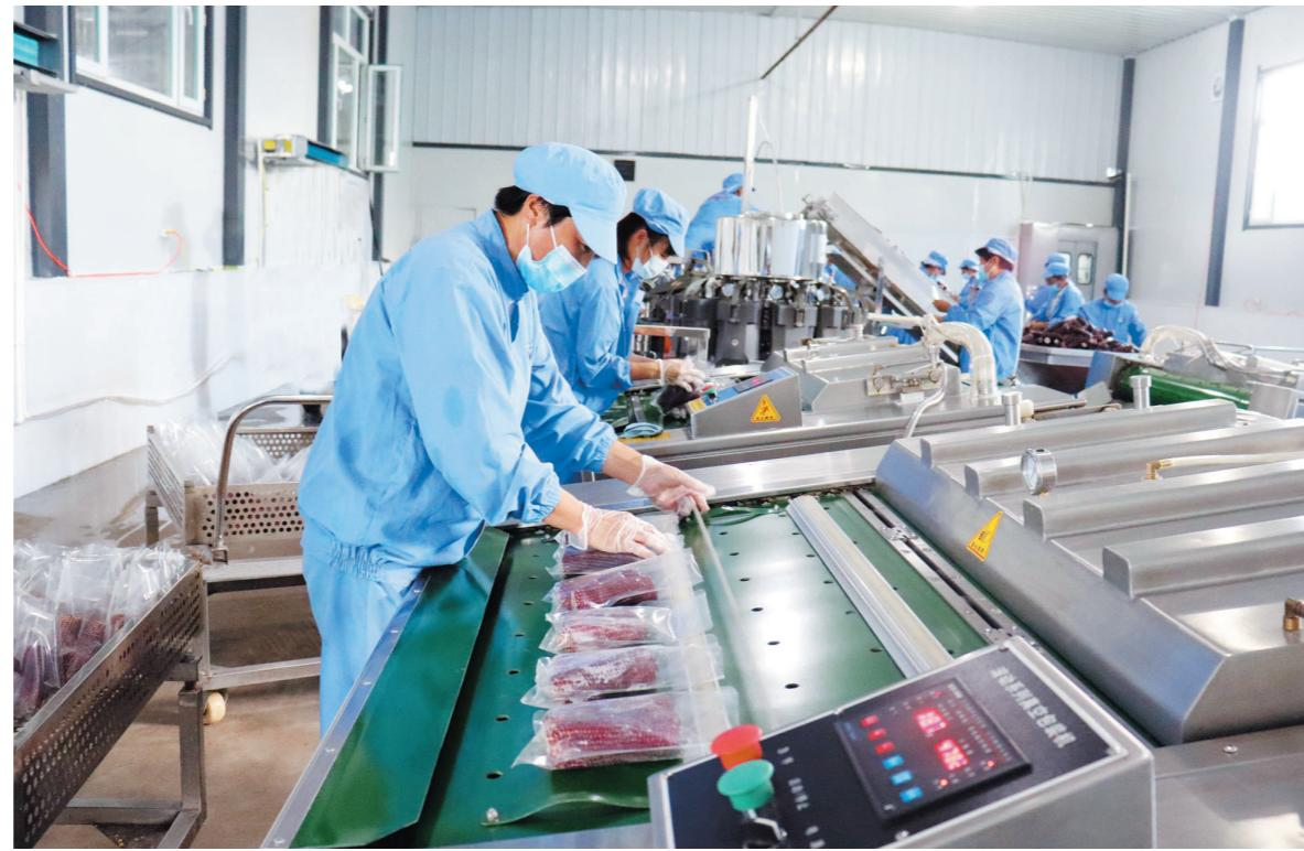
走进位于双辽市卧虎镇协力村的双辽市缘通农业农机专业合作社，生产车间里一片繁忙，不时有装满鲜食玉米的大斗车进院，合作社内的工人们正在忙着通过一系列加工流程包装玉米。玉米运送到车间去皮后，来到加工车间，经过上线、切割、头道清洗这三项粗加工后，符合标准的玉米正式走进了深加工环节。经纯净水高压冲洗、人工分拣入袋，“罐头工艺”真空封口等环节，半成品的玉米就加工好了。随后就是最关键的环节——高温杀菌，在高温杀菌仓内，半成品的玉米完成了最后的蜕变，华丽转身为可即食的纯天然无污染营养食品，走进百姓的餐桌。
