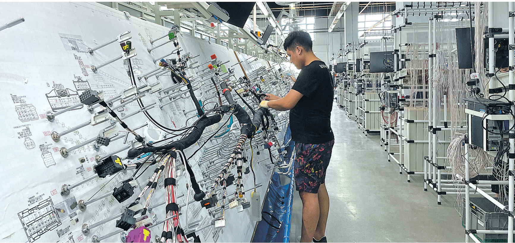
吉林华凯比克希线束有限公司位于四平市经济开发区,总建筑面积2万平方米,主要为一汽解放J6、J7重卡生产配套线束产品。预计年产值1.8亿元,税收700万元,提供就业岗位500个。这是该公司员工在生产车间进行线束组装。
