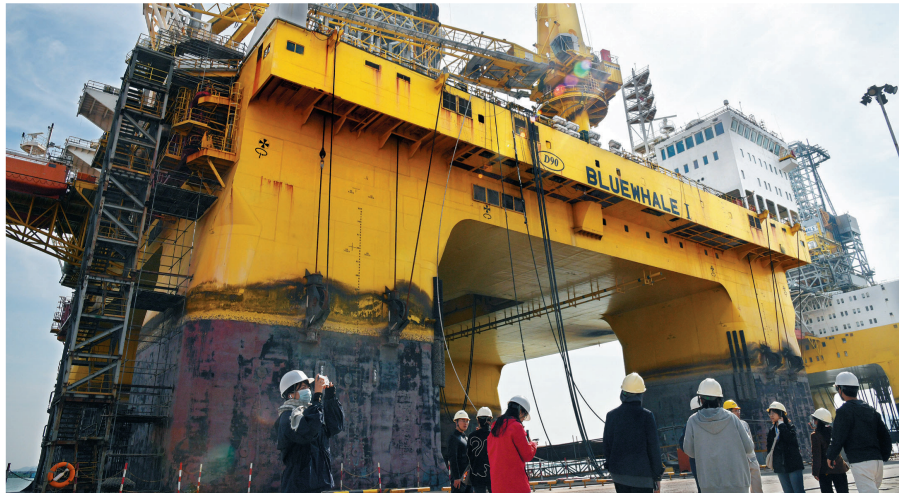
近期，曾经在我国南海成功试采可燃冰的大型海工装备“蓝鲸1号”及姊妹平台“蓝鲸2号”正在其生产地——中集来福士海洋工程有限公司烟台基地进行维护和保养。据了解，2017年2月交付的“蓝鲸1号”最大作业水深3658米，适用于全球深海作业。10月18日，参观者在中集来福士海洋工程有限公司深水码头参观。
